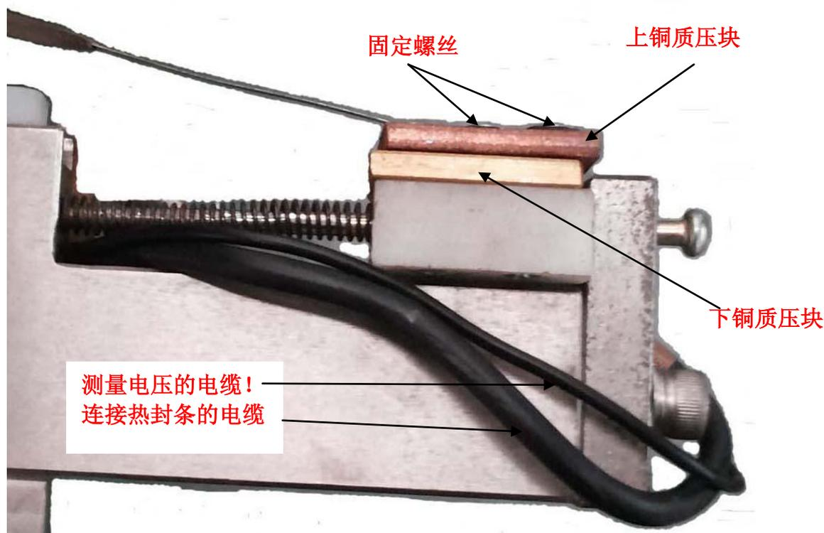
**下铜质压块:** 固定在绝缘塑料块: 中间铣槽, 根据热封条宽度: 如 5mm 热封条, 铣槽宽 5mm!
